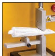
TA-TEF Зажимное устройство для выдавливания из тубика
