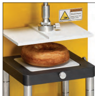
TA-CTP F Компрессионная верхняя пластина для приложения однородной силы сжатия к образцам с размерами вплоть до 4х6 дюймов (10 x 15 см). Необходим опорный стол для креплений образцов.
