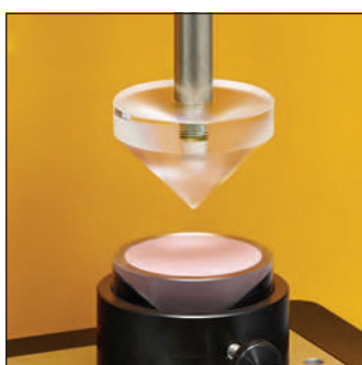
TA-STF C P F Крепительное приспособление для испытаний на размазывание измеряет усилие для размазывания материала. Поставляется с 1 датчиком с внешним конусом, 5 чашками для образцов и 1 держателем чашки для образцов. Необходим опорный стол для креплений образцов.
