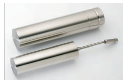
Камера для образца и шпindel из нержавеющей стали 316
