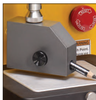
TA-EP C M Крепительное приспособление для карандаша для подводки глаз измеряет твердость кончиков косметических карандашей подводки глаз или губ, оно может также использоваться для кончиков гримировочных карандашей. Необходим опорный стол для креплений образцов.
