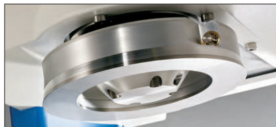
Крупный план крышки измерения пристеночного трения, используемой для испытания на пристеночное трение и на плотность.
