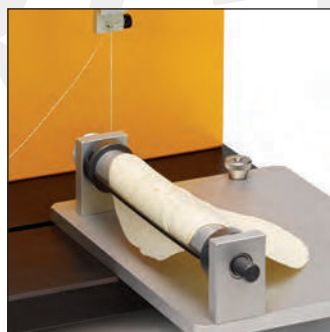
TA-TRF F Крепительным приспособлением для свертывания тортильи оценивают изменения текстуры зерновой тортильи согласно технической документации ААСС за счет измерения усилия для свертывания тортильи.
