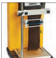
TA-HCF Зажимное устройство для измерения расчесываемости волос
