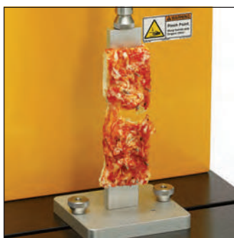
TA-PTF F M Зажимное приспособление для растяжения пиццы характеризует жесткость испеченной пиццы за счет измерения силы растяжения и длины деформации для разрыва образца.
