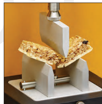
TA-TPB F Трехточечное изгибное крепление, используемое с лезвием TA7 из набора датчиков общего применения. Необходим опорный стол для креплений образцов. Доступна уменьшенная версия TA-JTPB.
