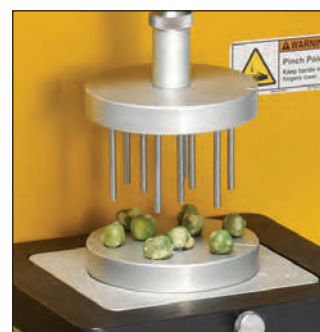
TA-JMPA F P Узел из нескольких датчиков, состоящий из девяти 3 мм датчиков и опорной пластины, предназначенной для удержания девяти малых образцов нестандартной формы. Необходим опорный стол для креплений образцов.
