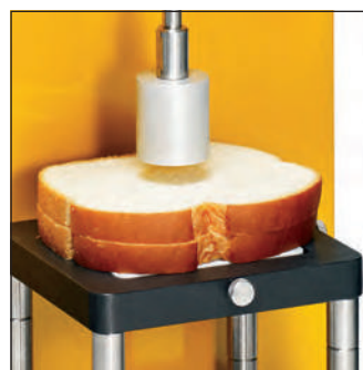
TA-AACC36 F Датчик для образцов ААСС для измерения жесткости хлеба и выполнения анализа профиля текстуры. Необходим опорный стол для креплений образцов.
