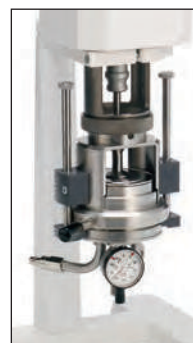
Вариант конус/плита обеспечивает расширенный диапазон скорости сдвига и вязкости
