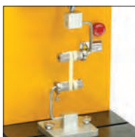
TA-NTF Крепежное приспособление для растяжения лапши
