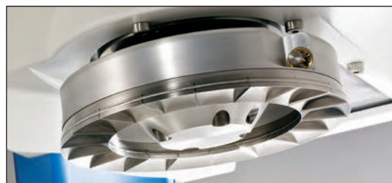
Крупный план лопаточной крышки, используемой для испытания на функцию текучести.
