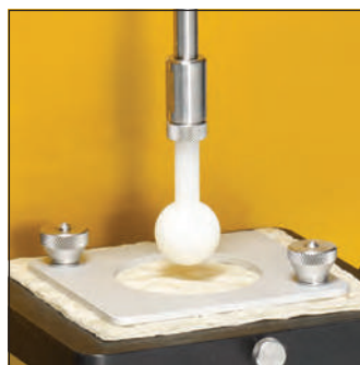
TA-DE F Крепежное приспособление для измерения растяжимости теста, используемое для удержания пластины сырого теста или хлеба для измерения точки разрыва растянутого образца. Необходим опорный стол для креплений образцов.
