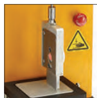
TA-BLS Зажимное приспособление для испытания на двойной сдвиг
