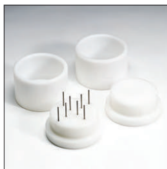
TA-FMBRA F Набор стандартных емкостей для теста, используемый для подготовки образцов теста и измерения уровня жесткости теста.
