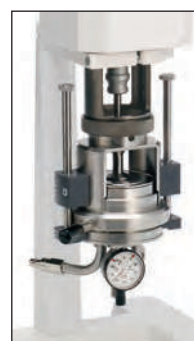
Вариант конус-плита обеспечивает расширенный диапазон скорости сдвига и вязкости
