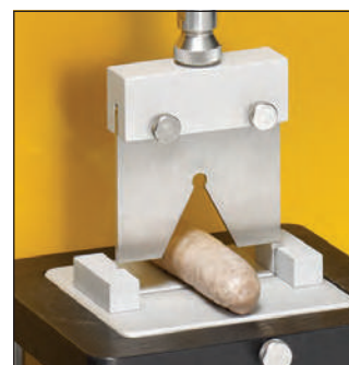
TA-SBA F Ножевое полотно для продуктов, у которых важна характеристика сдвига и разреза: мясо, рыба, колбаса и т.д. Необходим опорный стол для креплений образцов.
